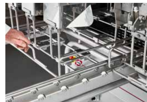
Das Rack wird direkt in der Spülmaschine ohne anstrengende Heben von der Bediener eingeschoben.
