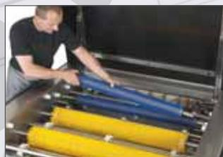
Schnellkupplungssystem sichern ein einfaches ausmontieren, somit die gereinigt werden kann. Die ganze Maschine kann mit einem Dampfreiniger gereinigt werden.
