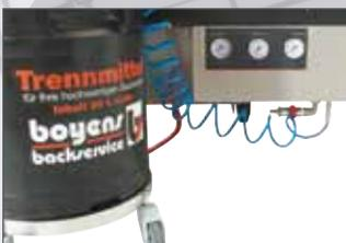
Neu-entwickelte Spray System, des hygienischen KEG-Rücknahmesystem mit 6 Düsen in Reihe, sorgen für ein gleichmässiger Beölung der Blechen.
