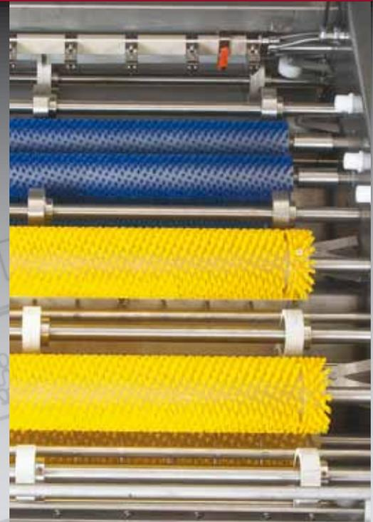
**Dass System für Groß-Bäckereien mit einem Bedarf zur Reinigung und automatischen Beölung von 800 - 1.000 pro Stunde. Die Blechen werden mit der Backseite nach oben gereinigt und beölt.**
