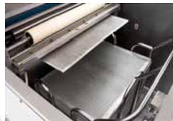
Die Bleche werden durch dass einzigartige Bürstensystem geführt und fallen direkt in den Blechwagen.
