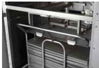
Ein Vakuumsystem hebt durch Pneumatik mit 4 Ansaugpunkten die Bleche vom Ablagewagen in das Reinigungssystem.
