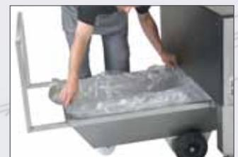
Gelöster Schmutz der Bleche fällt in einen Schmutzablagewagen, der für eine leichte Entleerung auf Rädern montiert ist.
